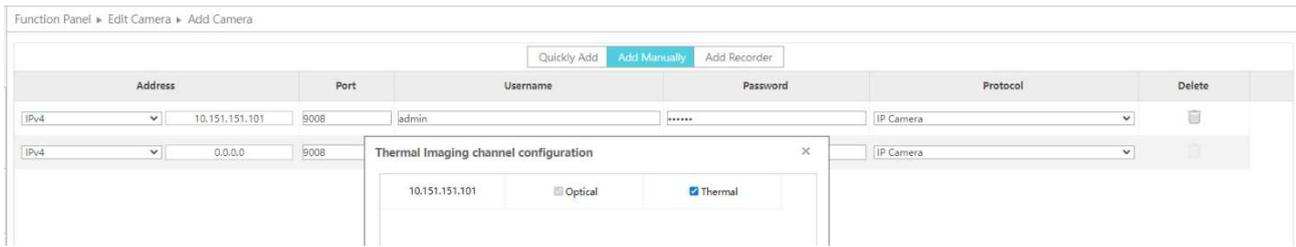
Una volta inserito indirizzo IP (lo stesso del canale visibile aggiunto in automatico), alla conferma il NVR chiede aggiunta del canale termico come da immagine sopra, confermando la telecamera termica viene aggiunta.
